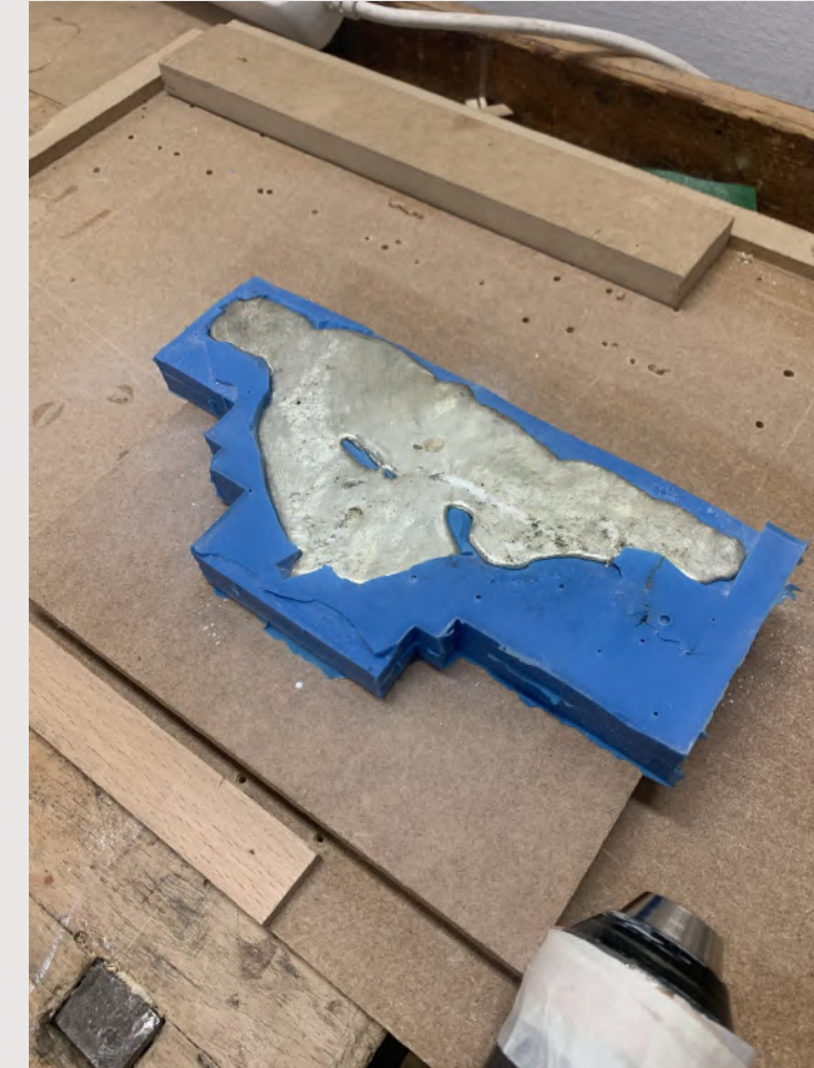
Mall för tenngjutning av beslaget
