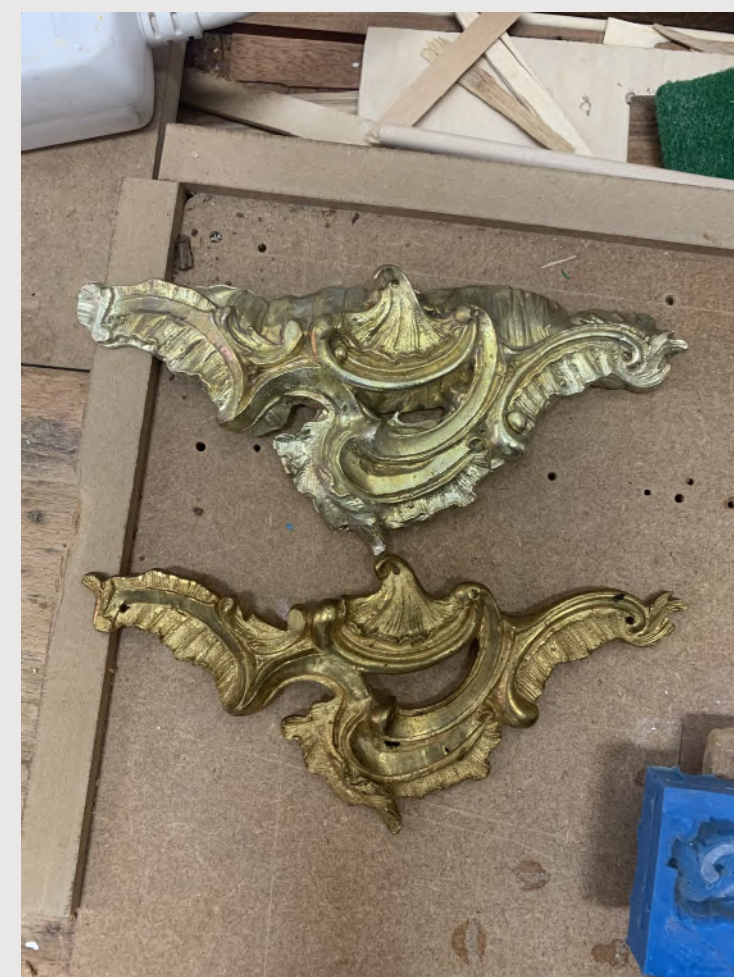
Resultat efter gjutning, innan justeringar
